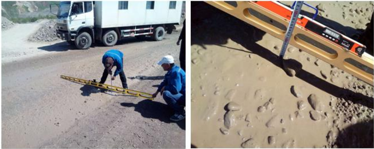
Рис. 4. Измерение неровностей карьерной дороги при помощи универсальной дорожной рейки РДУ «Кондор»
