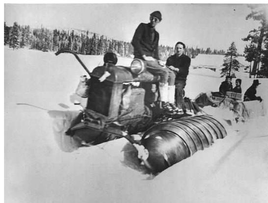
Рис. 15. Трактор «Fordson» на РВД «Снежный Дьявол» (1929 г.)
