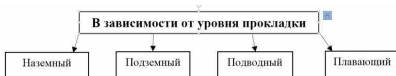
Рис. 1. Классификация трубопроводов в зависимости от уровня прокладки
