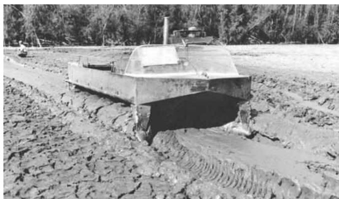
Рис. 23. Испытания Marsh Screw на заиленной местности
