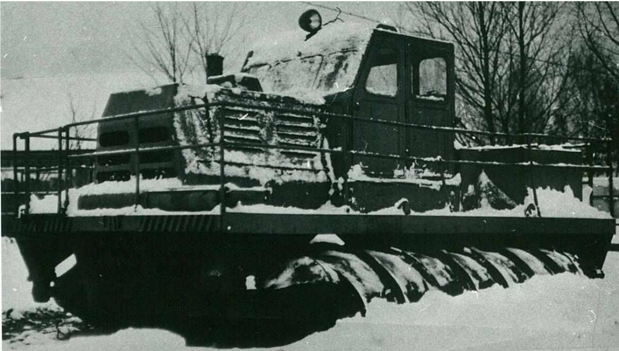
Рис. 35. Снегоболотоход на РВД разработки МИНХ им. Губкина
