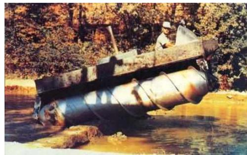
Рис. 22. Снегоболотоход Marsh Screw (1964 г.)
