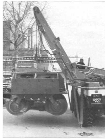
Рис. 47. Транспортировка и разгрузка машины на РВД – ЗиЛ-2906
