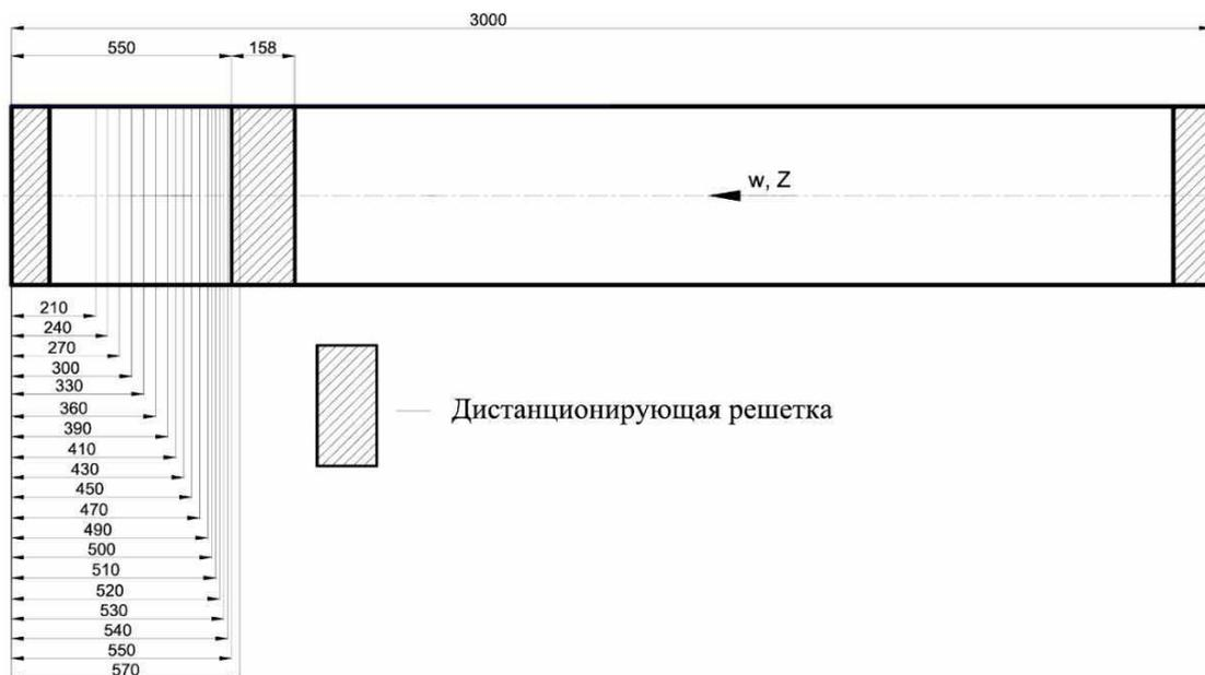
Рис. 5. Схема расположения сечений измерения гидродинамических характеристик по длине ЭМ
