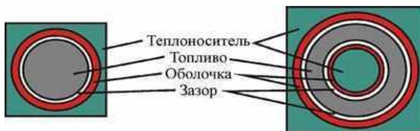
Рис. 1. Конструкция кольцевого и стержневого ТВЭЛ
