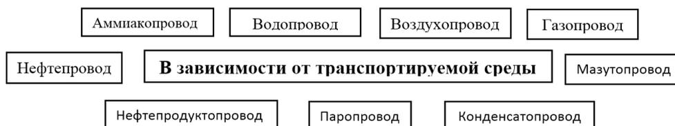
Рис. 2. Классификация трубопроводов в зависимости от транспортируемой среды
