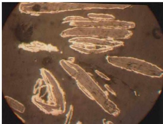
**Рис. 6. Структура частиц порошка НПГ-80. В центре частиц расположен графит, окруженный слоем никеля толщиной 9 мкм. Увеличение 130**
