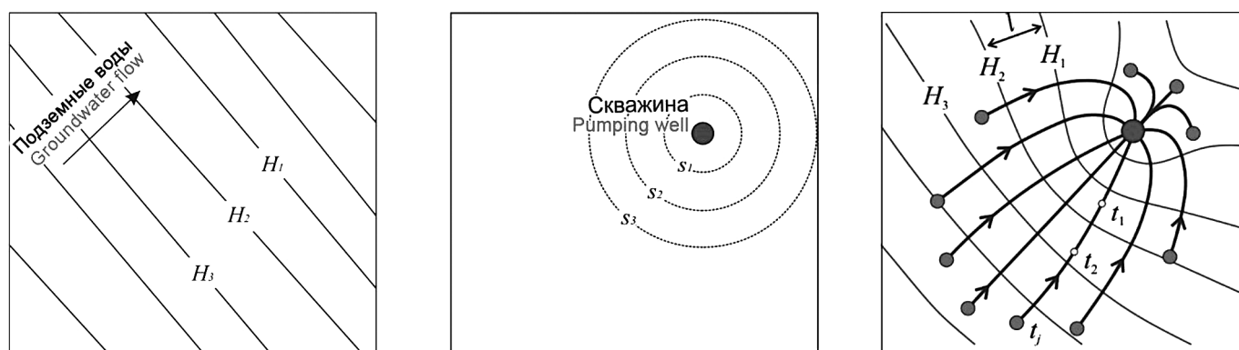
Рис. 1. Принцип расчёта ЗСО подземного водозабора графоаналитическим методом.
